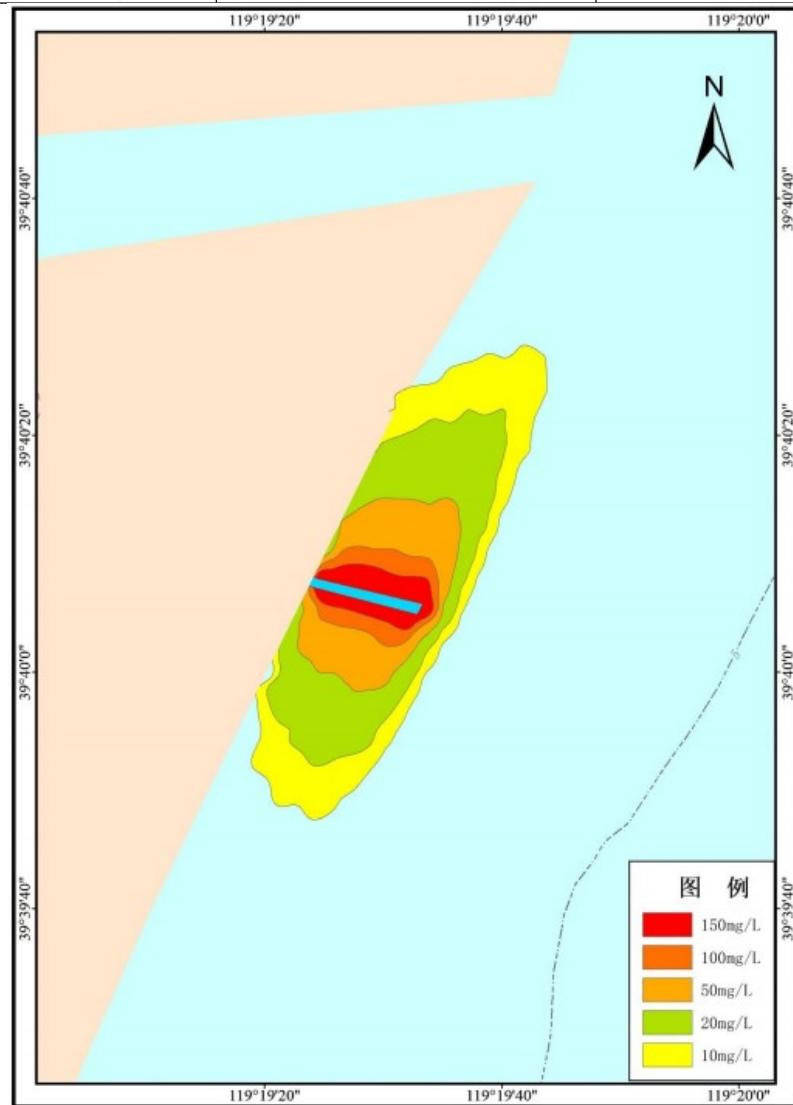
图 4-1 项目施工悬沙最大包络范围示意图
