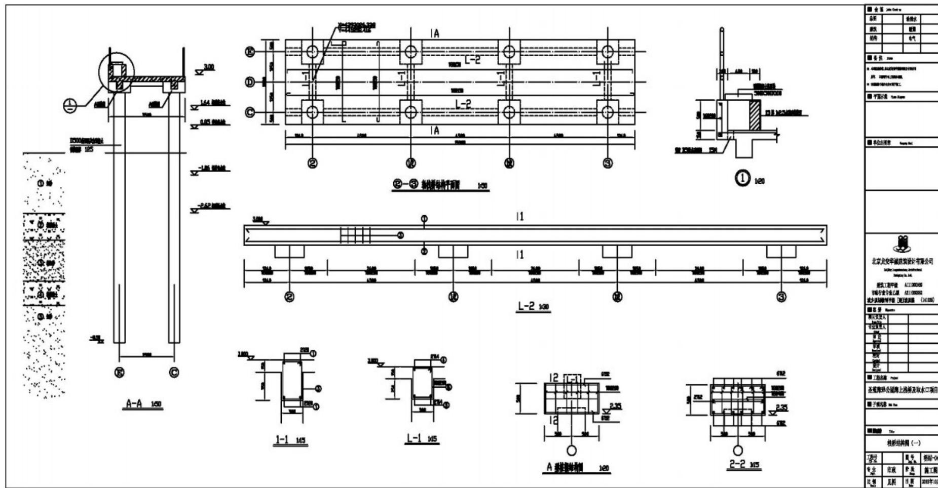
附图 6 栈桥及桩基结构图
