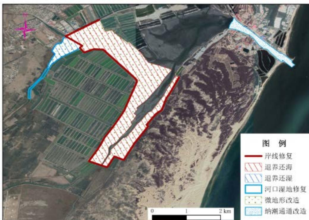
图 2.2-15 秦皇岛七里海海洋生态保护修复工程布置图
