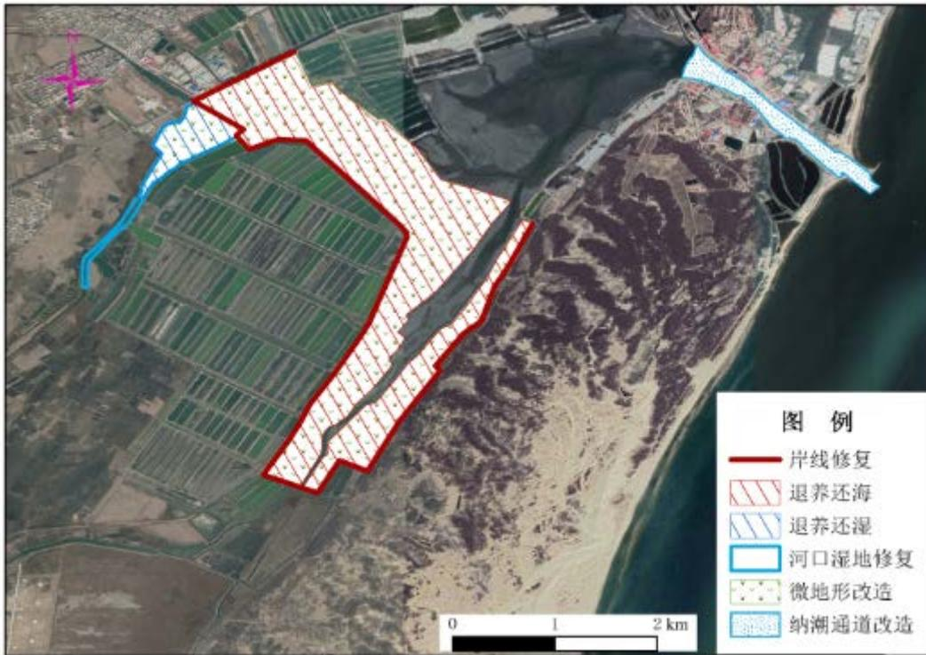
图 2.2-4 秦皇岛市七里海海洋生态保护修复工程布置图
