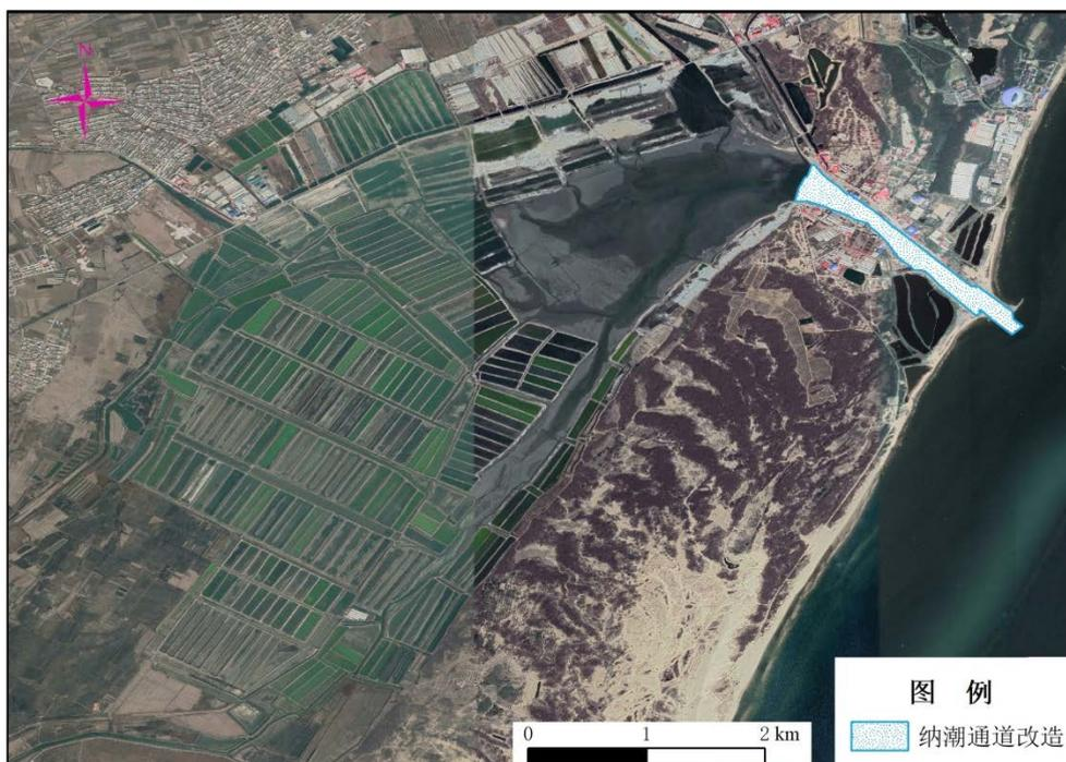
图 2.2-8 秦皇岛市七里海海洋生态保护修复工程纳潮通道改造布置图
