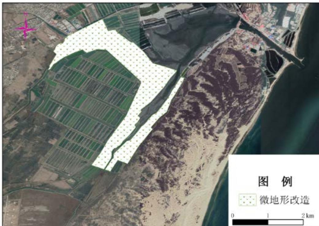
图 2.2-6 秦皇岛市七里海海洋生态保护修复工程微地形改造布置图
