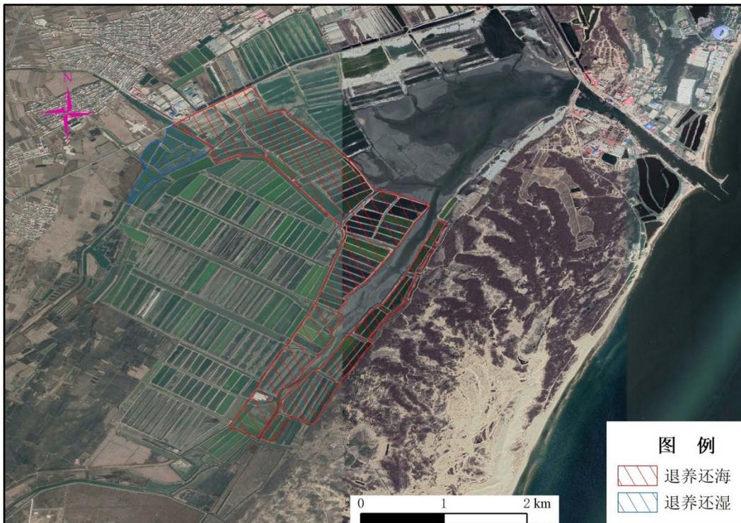
图 2.2-5 秦皇岛市七里海海洋生态保护修复工程养殖清退布置图
