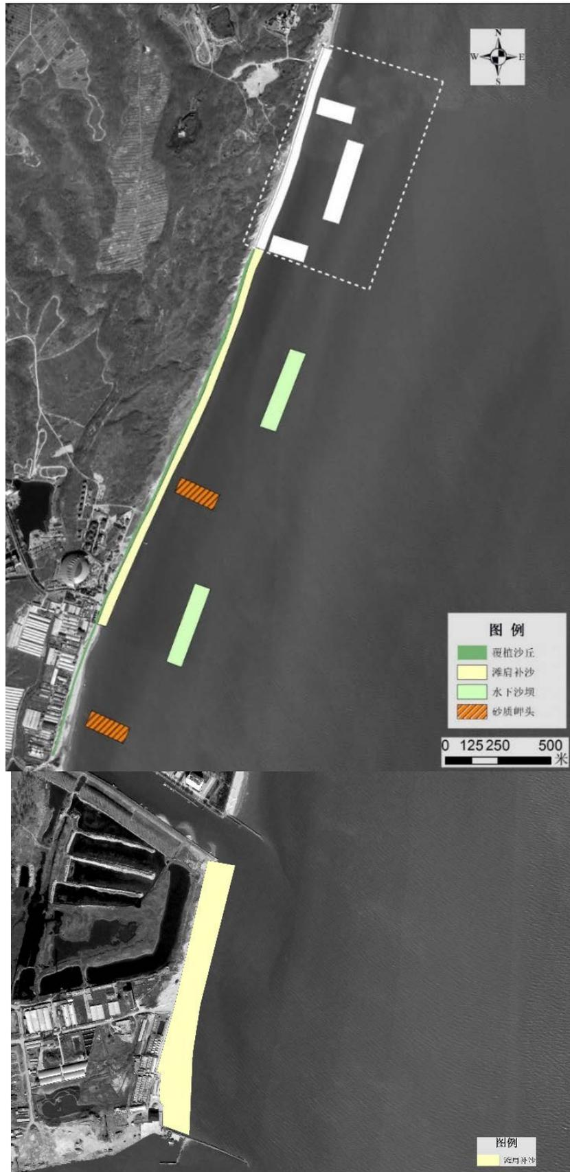
图 2.2-3 秦皇岛市金沙湾海洋生态保护修复工程砂质海岸生态减灾工程布置图（白框内属于秦皇岛市金沙湾及大蒲河河口海岸带保护修复工程）
