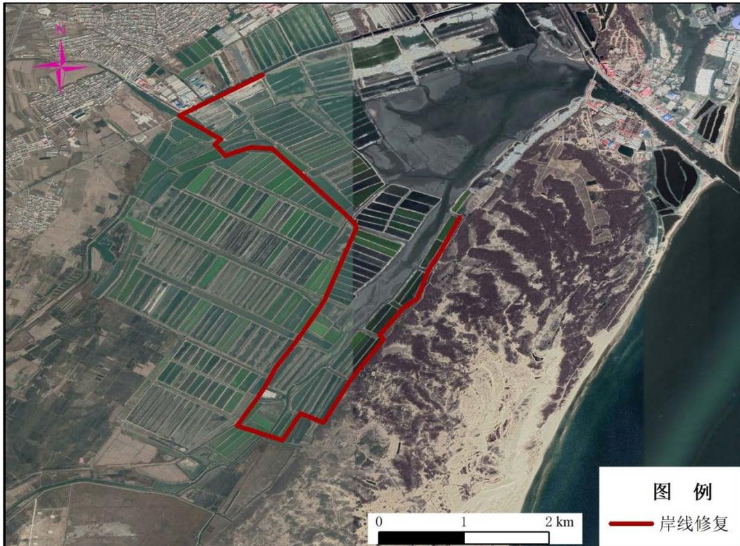
图 2.2-18 岸线修复工程布置图
